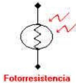
Hay muchas aplicaciones en las que una fotorresistencia es muy útil, como el circuito: Luz nocturna de encendido automático, que utiliza una fotorresistencia para activar una o más luces al llegar la noche o el Relay controlado por luz, donde el estado de iluminación de la fotorresistencia, activa o desactiva un Relay, que puede tener un gran número de aplicaciones.
